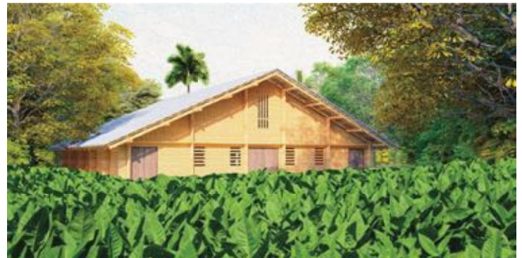
Figura 9. Propuesta del uso del bambú en componentes de paredes y estructura del techo de una casa de tabaco para la reconstrucción pos-desastre. Fuente: Ramírez y Moreno, 2024 [31].
