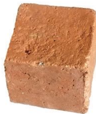
Figura 3. Muestra de material experimental de construcción económico, ecológico, ahorrador de energía, y con excelentes prestaciones físico-resistentes, elaborado con residuos industriales, sin incluir cemento, producido en 1992 en la Facultad de Arquitectura del ISPJAE. Fuente: Archivo personal de Alfonso Alfonso.
