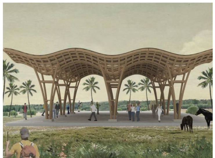
Figura 10. Propuesta del uso del bambú en el diseño de componentes de techos en instalaciones productivas. Fuente: Ramírez y Moreno, 2024 [31].
