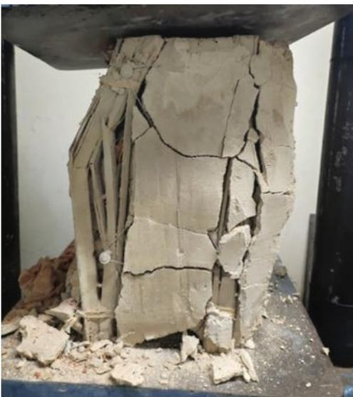
Figura 9. Falla por aplastamiento. Fuente: Elaboración propia.
