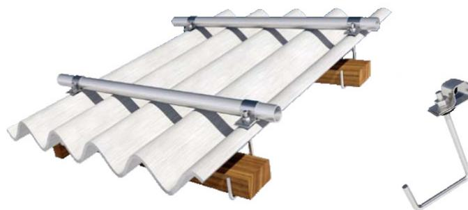
Figura 7. Ejemplo de refuerzo permanente con tubos de acero galvanizado. Fuente: Solución de Mario C. Carbajo y Yosiel Ledesma. Catálogo de soluciones para viviendas tipología III ante el viento. Tesis de diploma, Facultad de Arquitectura, 2012.
