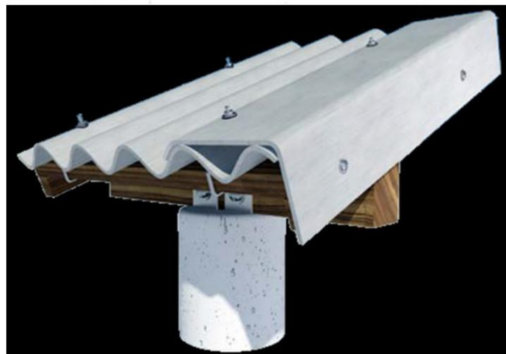
Figura 10. En el esquema superior derecha puede observarse que la teja de la esquina queda expuesta a la acción del viento. La pieza angular remata el borde. Fuente: Mario C. Carbajo y Yosiel Ledesma. Catálogo de soluciones para viviendas tipología III ante el viento. Tesis de diploma, Facultad de Arquitectura, 2012.
