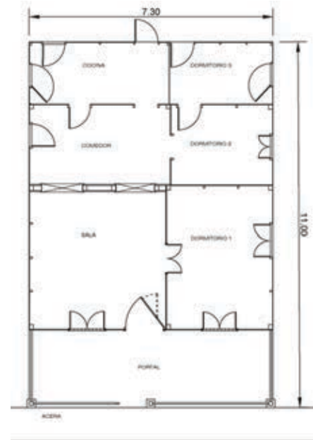
Figura 6. Planta de las casas construidas por la Asociación de Fabricación Unión y Progreso. Fuente: Autor.
