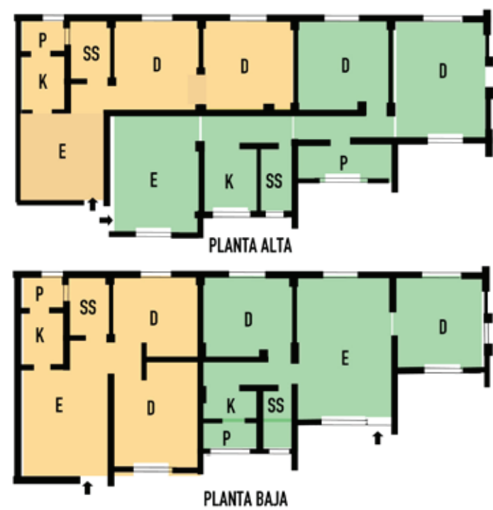
Figura 7. Plantas del edificio experimental con bloques prensados de suelo-cemento ejecutados en Cocosolo, Marianao, La Habana. Proyecto arquitectónico de Alfonso Alfonso y Gabriela Peterssen, con apoyo del CECAT y el Tropenbau. Fuente: Archivo de los autores, 1990.
