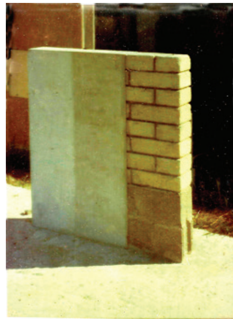
Figura 2. Testigo expuesto a la intemperie en el CECAT de bloques prensados de suelo-cemento con muestras de revocos diversos. Foto de Archivo de los autores, 1990.
