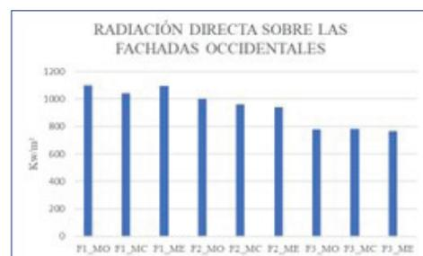
Figura 3. Incidencia de radiación solar en las fachadas localizadas al poniente. Fuente: Autores, 2022.
