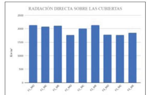
Figura 6. Incidencia de radiación solar directa sobre las cubiertas. Fuente: Autores, 2022.
