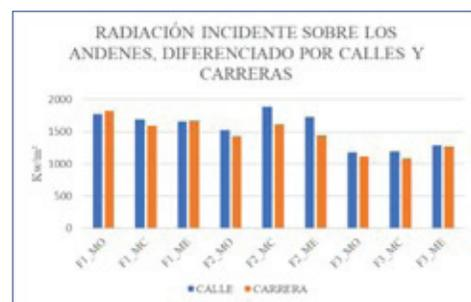
Figura 5. Incidencia de radiación solar sobre andenes de calles trazadas en sentido norte - sur, y oriente - occidente. Fuente: Autores, 2022.
