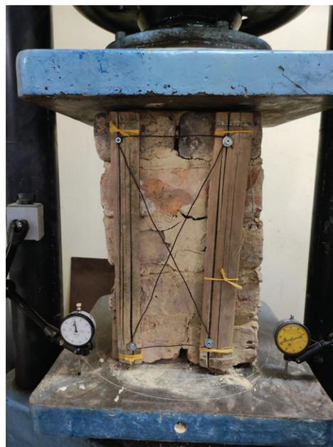
Figura 2. Murete tipo CR (compresión con refuerzo). Fuente: Elaboración propia.
