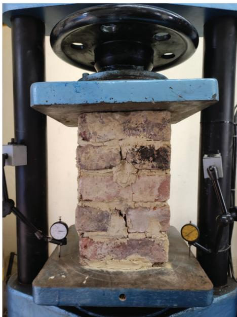
Figura 1. Murete tipo CSR (compresión sin refuerzo). Fuente: Elaboración propia.
