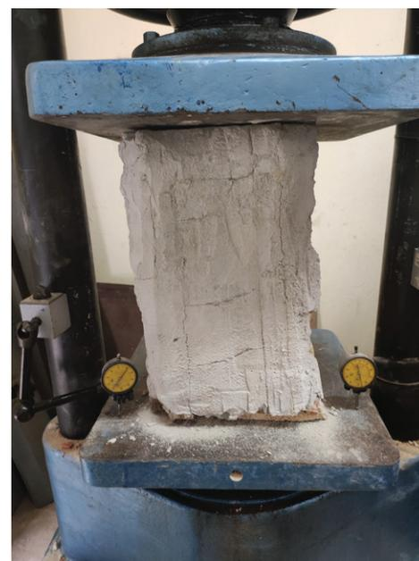
Figura 3. Murete tipo CRP (compresión con refuerzo y pañete). Fuente: Elaboración propia.
