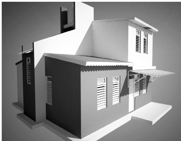
Figura 5. Propuesta de Vivienda evolutiva con núcleo refugio con techos de asbesto cemento convertidos en losas de hormigón armado. Fuente: Autor.
