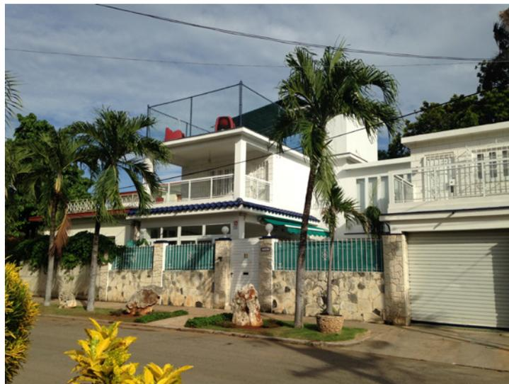
Figura 5. Ejemplo de vivienda en que se ha incorporado un muro que la separa de la calle, con enchapes y elementos decorativos, cierre del portal con paneles de aluminio y vidrio, y adición de tejas verdes en el borde del alero. Reparto Ampliación de Almendares, Playa. Fuente: Autoras.
