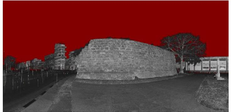
Figura 2. Nube de puntos sin procesar en la interfaz del programa Z+F Laser. Elaboración propia
