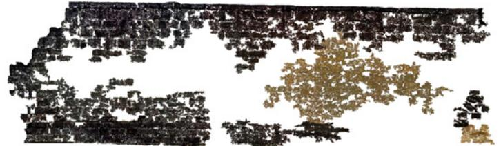
Figura 5. Determinación a través de ortoimagen del área ocupada por pátinas negras y naranjas. Elaboración propia.
