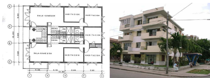
Figura 20: Edificio de apartamentos en Calle 17 esq. a 26, El Vedado, construido por las Microbrigadas en la década del 80. Especialmente crítica es la iluminación de la cocina a pesar de tratarse de una solución pareada (Elaborado por Ricardo Gómez).
