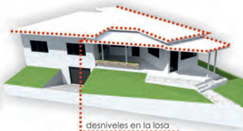
desniveles en la losa
