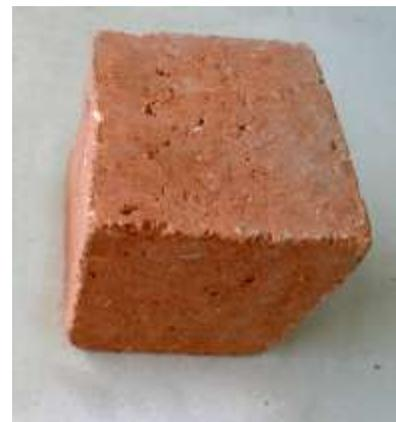
Figura 06: Muestra cuadriforme elaborada con suelo estabilizado con arcilla cocida triturada y residuo de cal apagada del vertedero de Río Verde. [Foto: autor]
