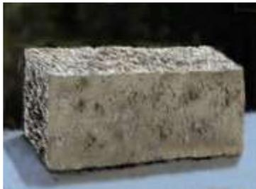
Figura 07 Espécimen sólido con cemento y lodo de papel mineralizado procedente de la fábrica de reciclado de papel San Francisco, en Baja California, elaborado en el CECAT con técnicas de inmersión prolongada [Foto: autor]
