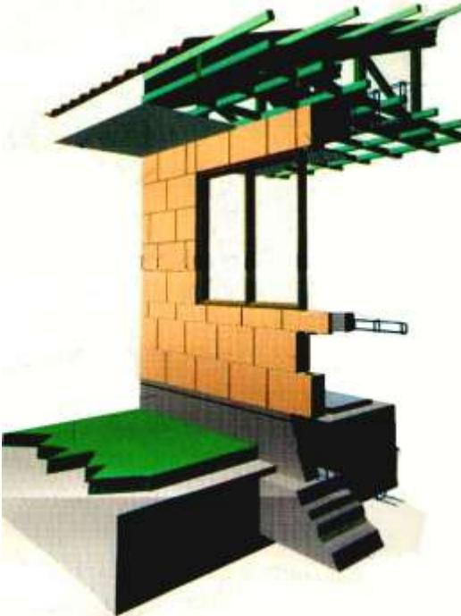
Figura 03. Sistema de construcción para viviendas compuesto con elementos producidos con desechos industriales procedentes del vertedero de Cochabamba, Bolivia, elaborado en 1998-99 en la Maestría en Ciencias de la Construcción desarrollada por el CECAT en la Universidad Mayor de San Simón por Buitrago y Gareca, con A. Alfonso como consultor y J. Flores tutor. [Foto: autor]
