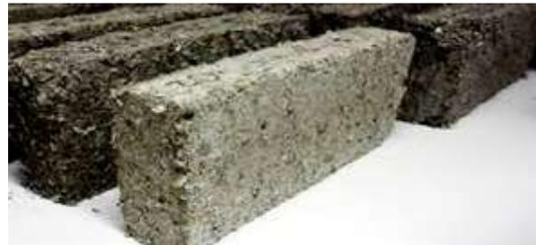
Figura 08 Muestra de ladrillo con lodo de papel producido por extrusión en la Escuela Politécnica Superior de Linares de la Universidad de Jaén Foto: [28].
