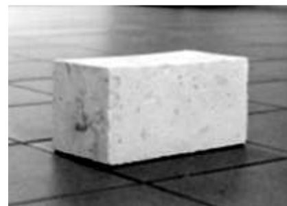
Figura 12: Bloque elaborado por investigadores de la Facultad de Arquitectura de Baja California (UABC), Mx., utilizando arena sílice y lodo de papel mineralizado. Foto:
