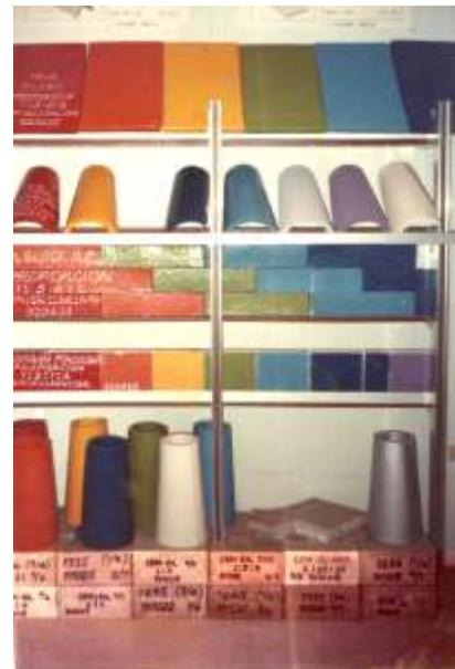
Figura 11: Elementos diversos de construcción elaborados por en Mexicali a principios de la década de los años 90, utilizando residuos de arena sílice de Cerro Prieto, Mx. [Foto: autor]
