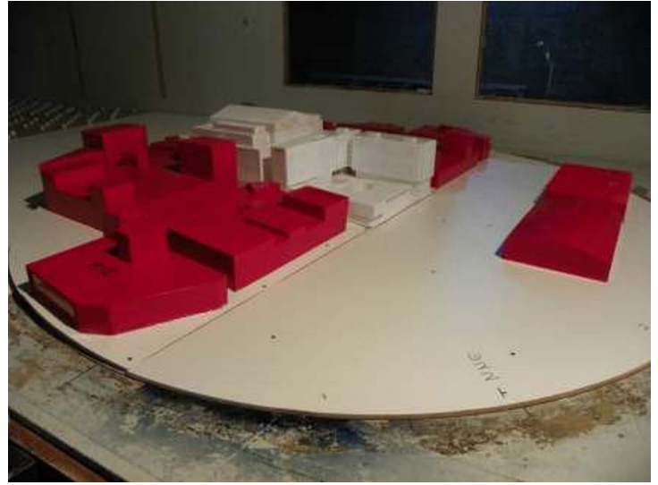
Figura 6: Modelo instalado para ensayar dirección de viento SURSURESTE.
