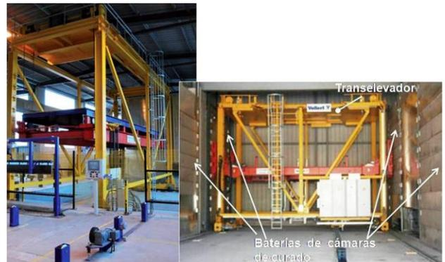
Figura 15: Transelevador recibiendo el molde en el área de hormigonado para su traslado hacia la zona de curado e introducción en la cámara que corresponda. Fuente: <https://www.youtube.com/VollertAnlagenbau>
