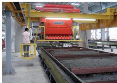
Figura 12: Automatización del proceso de hormigonado en los moldes. Fuente: <https://www.youtube.com/VollertAnlagenbau>
