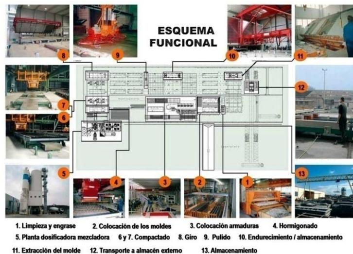
Figura 10: Esquema funcional de todo el proceso de producción móvil. Fuente: <https://www.avermann.com>
