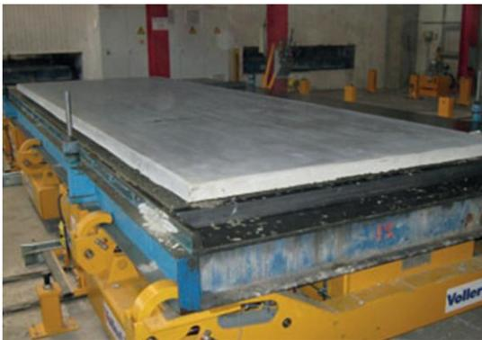
Figura 14: Estación de compactación de baja frecuencia. Proceso prácticamente silencioso que garantiza la total eliminación de la segregación del hormigón. Fuente: <https://www.youtube.com/VollertAnlagenbau>
