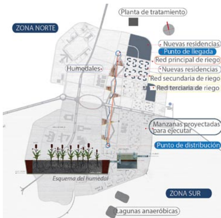
Figura 18: Plano del humedal de tratamiento de las aguas grises. (GONZÁLEZ MILIÁN, Nataly. 2013).
