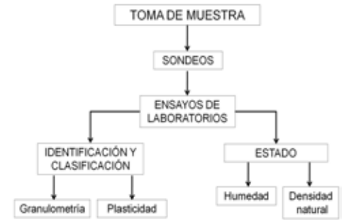
Figura 5: Esquema experimental de los ensayos de caracterización de suelo.
