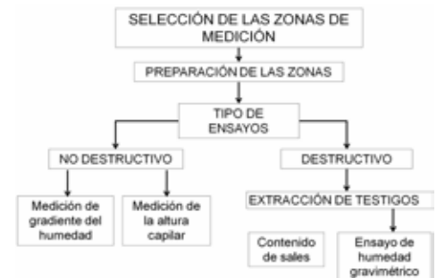
Figura 6: Esquema experimental de los ensayos patológicos.
