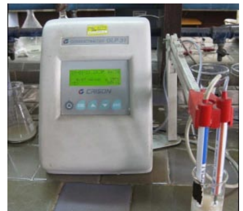
Figura 10. Conductímetro utilizado en las mediciones de conductividad eléctrica. Fuente: autores.
