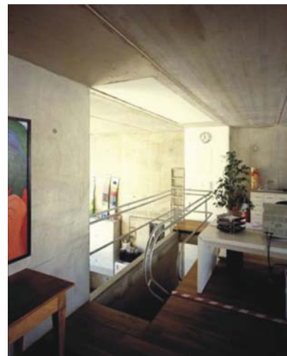
Figura 19: La superficie habitable puede aumentar notablemente mediante la subdivisión de espacios que en la etapa inicial tienen puntal doble. Proyecto Kolner Brett, Brandlhuber and Kniess, Alemania, 1999. (Tomada de http://www.afewthoughts.co.uk , marzo 2010)
