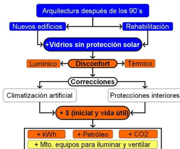
Figura 10. Esquema que sintetiza la problemática del uso de la carpintería de vidrio sin control solar en la arquitectura.
